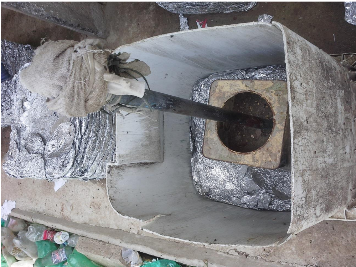
Foto 37. Manejo das quintinhas para a reciclagem em blocos de alumínio.
