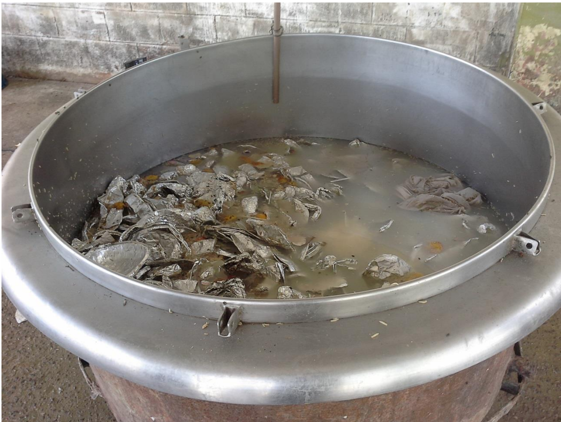
Foto 35. Caldeirão onde se limpam as "quentinhas" para a reciclagem do alumínio.
